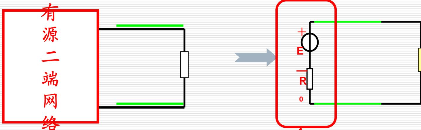
**有源二端网络**: 具有两个出线端的部分电路，其中含有电源，它可以是简单的或任意复杂的电路，但不论结构如何，对所计算的支路而言，仅相当一个**电源**。
